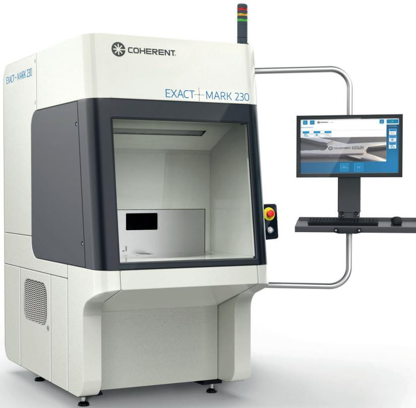
2 Schlüsselfertige Systeme für das Black Marking sind in sich geschlossene Arbeitsplätze, einschließlich einer optionalen Roboterschnittstelle und Absaugsystem (© Coherent)
